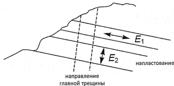
Рисунок 5.1 – Визуализация концепции модели трещиноватой породы
