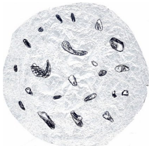
Рисунок 2.17 - Контакт крупных частиц галечникового грунта со штампом: а) при горизонтальном расположении частиц; б) при вертикальном расположении частиц
