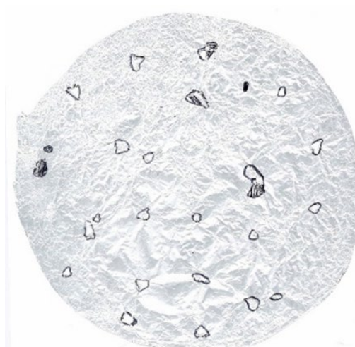
Рисунок 2.17 - Контакт крупных частиц галечникового грунта со штампом: а) при горизонтальном расположении частиц; б) при вертикальном расположении частиц
