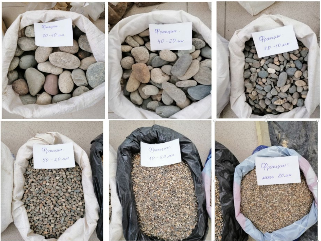
Рисунок 2.5 – Рассев гравийно-галечникового грунта на отдельные фракции
