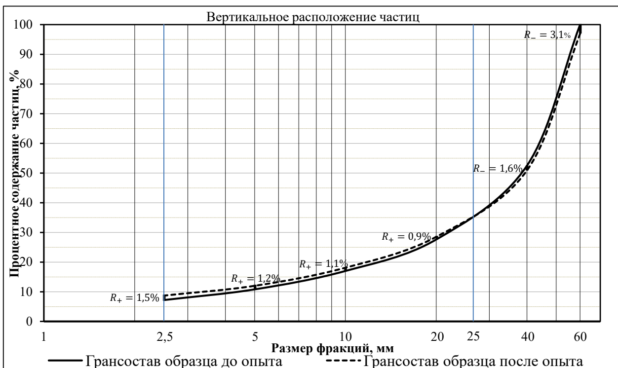
Рисунок 2.14 – Изменение грансостава после эксперимента при вертикальном расположении частиц d \geq 10 мм
