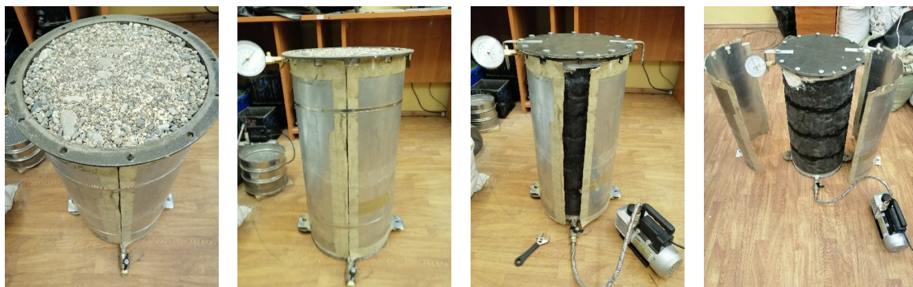
Рисунок 2.21 – Съемная опалубка вакуумного прибора
