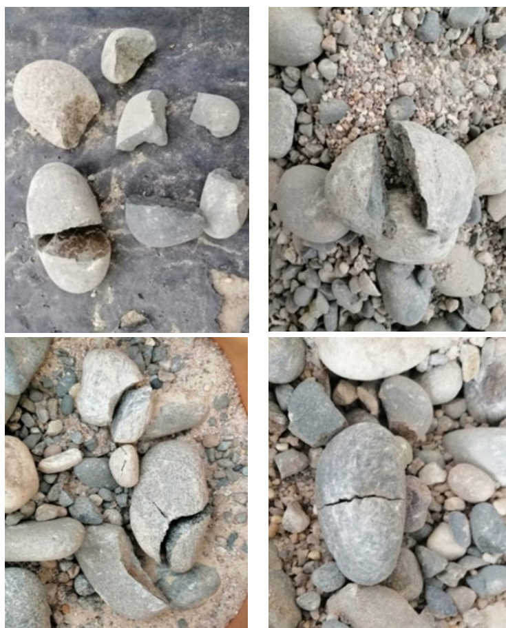
Рисунок 2.12 – Разрушение частиц галечника (Изменение гранулометрического состава)
